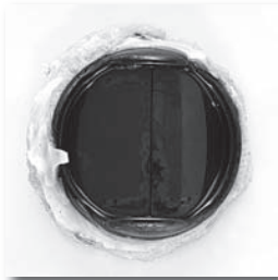
Rys.4. Przykład zmian na powierzchni reimplantowanej zastawki dwudyskowej (fot. M. Jakubowski, Pracownia Biocybernetyki)
